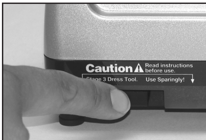
Рисунок 11. Используйте инструменты очистки осторожно и только когда необходимо (см. инструкции на следующих страницах).
