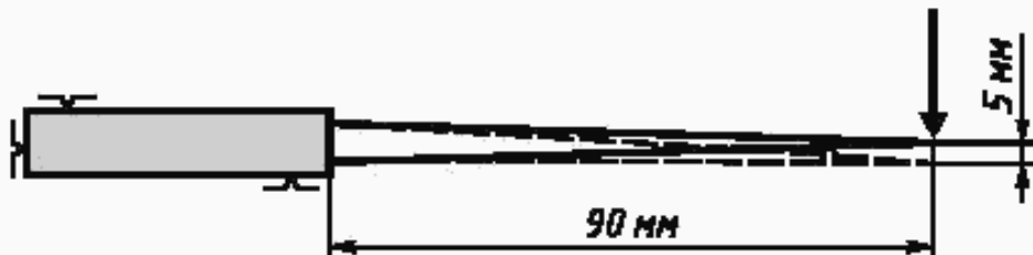
Рисунок 1 — Схема проведения испытаний на прочность и упругость туристических и специальных спортивных ножей
